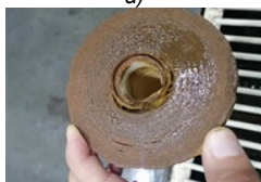
Рисунок 6. Фильтр картриджного типа до проведения испытаний Figure 6. Cartridge type filter before test
