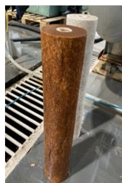
Рисунок 8. Фото фильтрующего элемента после завершения длительных испытаний Figure 7. Photo of the filter element after completion of long-term tests
