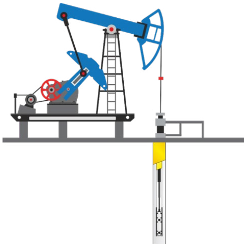
Рисунок 3. Схема работы штанговой скважинной насосной установки Figure 3. Schematic diagram of sucker rod
