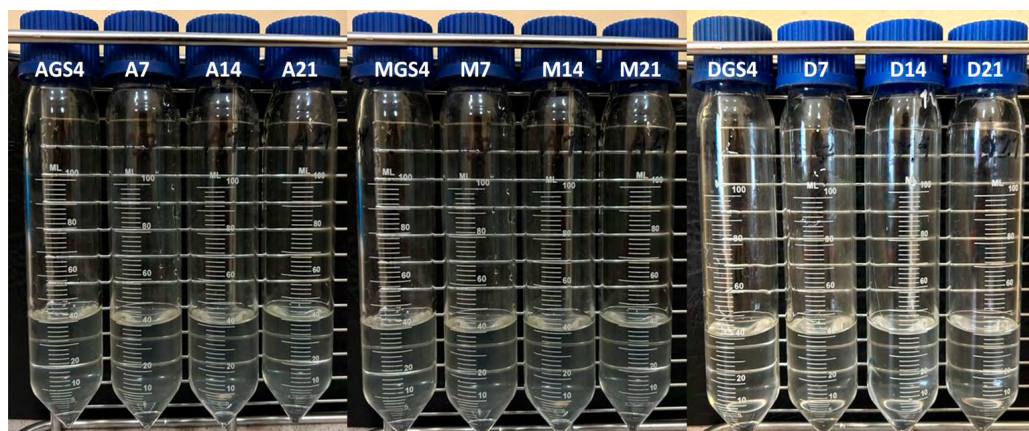
Рисунок 6. Пробы геланта до размещения в термошкафу Figure 6. Gelant samples before placement in the thermostatic chamber
