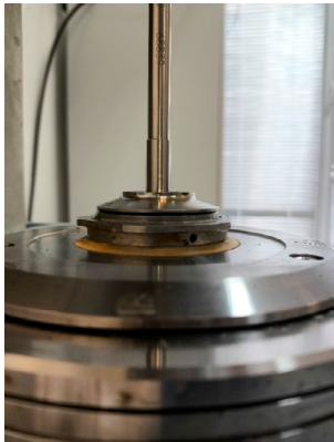
Рисунок 2. Внешний вид пластин автоматического реометра с интервалом между ними 1 мм Figure 2. Appearance of automatic rheometer plates with 1 mm gap
