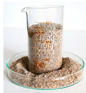
Рисунок 3. Эффект гравитационной сегрегации, наблюдаемой при перемещении шихты Figure 3. Effect of gravitational segregation observed during batch movement
