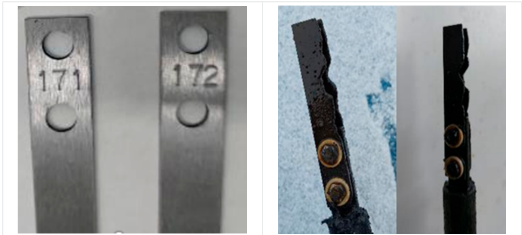
Рисунок 5. Внешний вид ОСК до и после установки на ЦППН «А» Figure 5. Appearance of corrosion coupons before and after installation at OPPS “A” а) до испытания / before testing; б) после испытания / after testing
