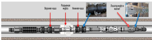
Рисунок 11. Схематическая конструкция селективного пакера
