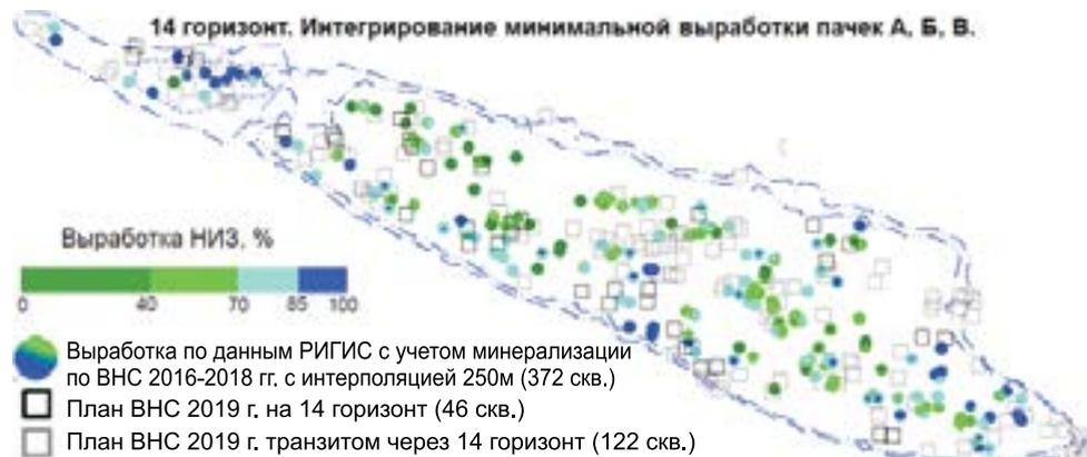
**Рисунок 9. Карта выработки начальных извлекаемых запасов по 14 горизонту с разбивкой на пачки по данным РИГИС с учетом текущей минерализации по данным замеров**
