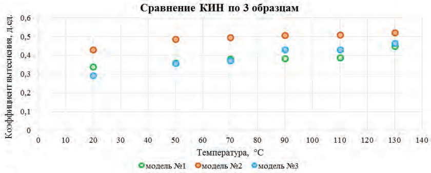
Рисунок 8. Влияние температуры на коэффициент вытеснения
