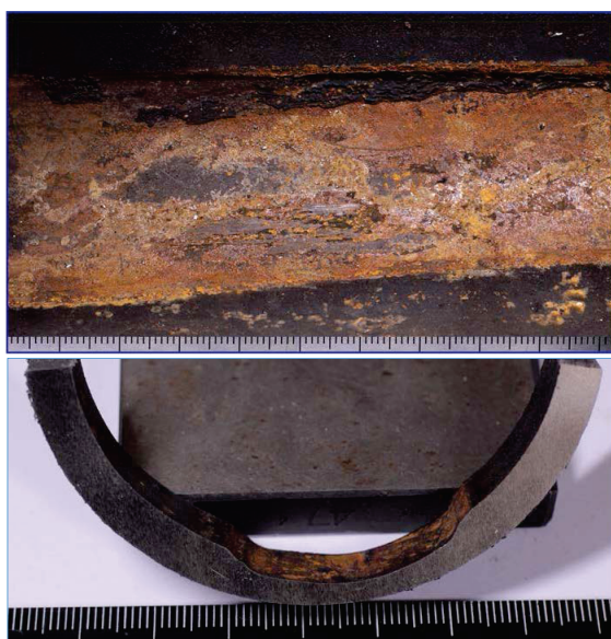
Рисунок 2. Вид сечения внутренней поверхности НКТ (вблизи nipple'ного конца)
