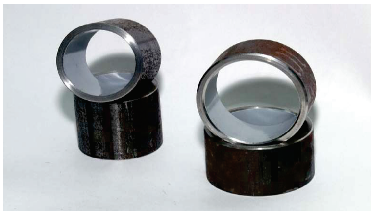
Рисунок 4. НКТ с полимерным покрытием ПЭП-585
