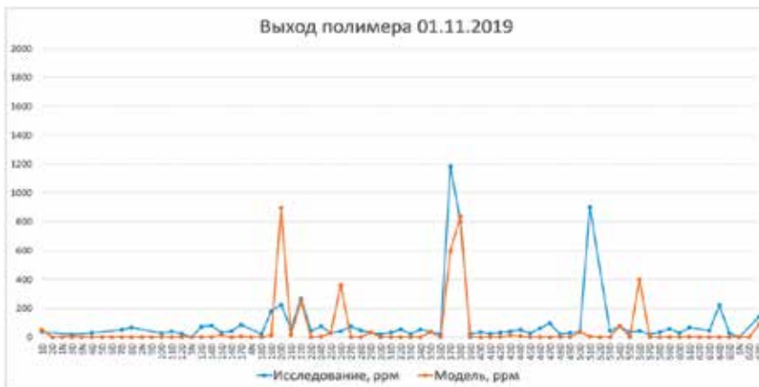
Рисунок 15. Сопоставление концентрации выхода полимера (фактическая и модельная) по добывающим скважинам
