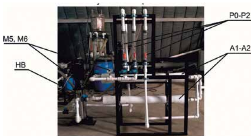
Установка - установка обратноосмотическая A1...A2-аппарат обратноосмотический 1м NB-насос высокого давления P0-P2-расходомер 100-1000 л/час M5,M6- манометры показывающие 1...25 бар
