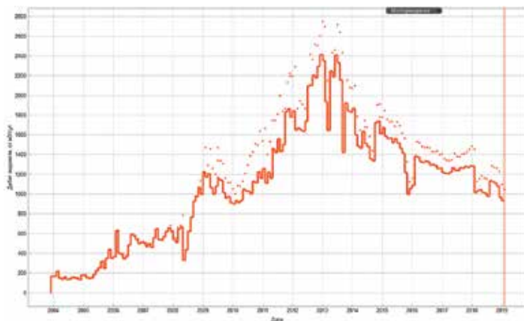
Рисунок 17. Адаптация динамики добычи по нефти с добавлением проницаемости DFN (красные точки – фактический дебит нефти, красная линия – дебит нефти обновленной ГДМ)
