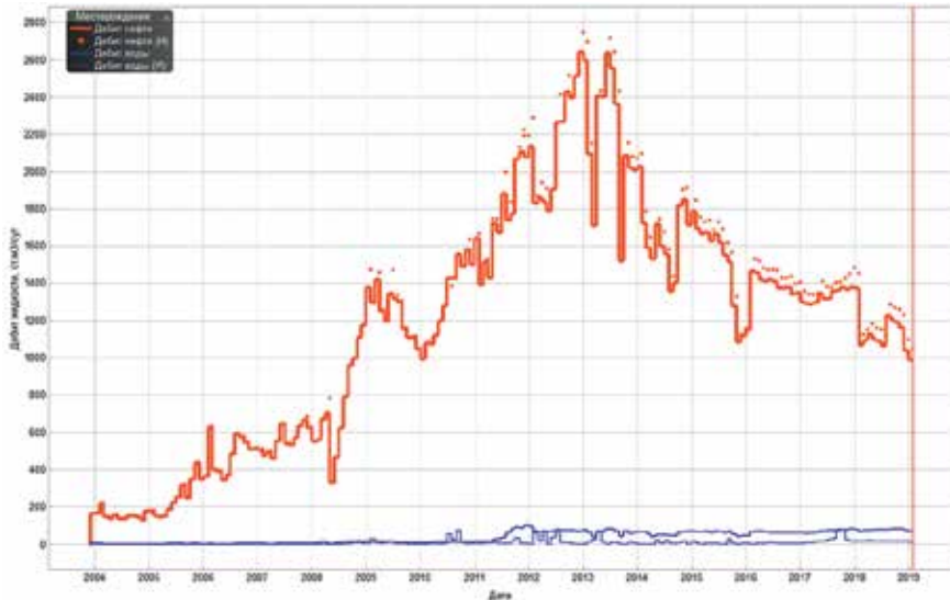
Рисунок 19. Адаптация динамики добычи по нефти и воде с добавлением проводимости разломов
