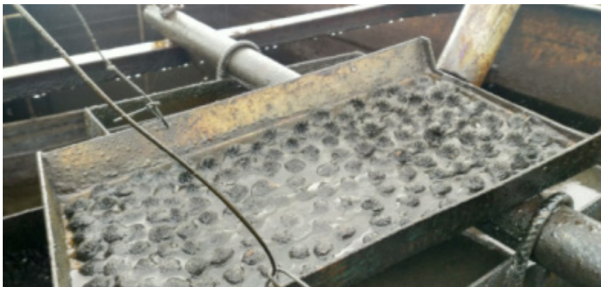
Рисунок 4. Вынос стружки в процессе фрезерования «окна»
