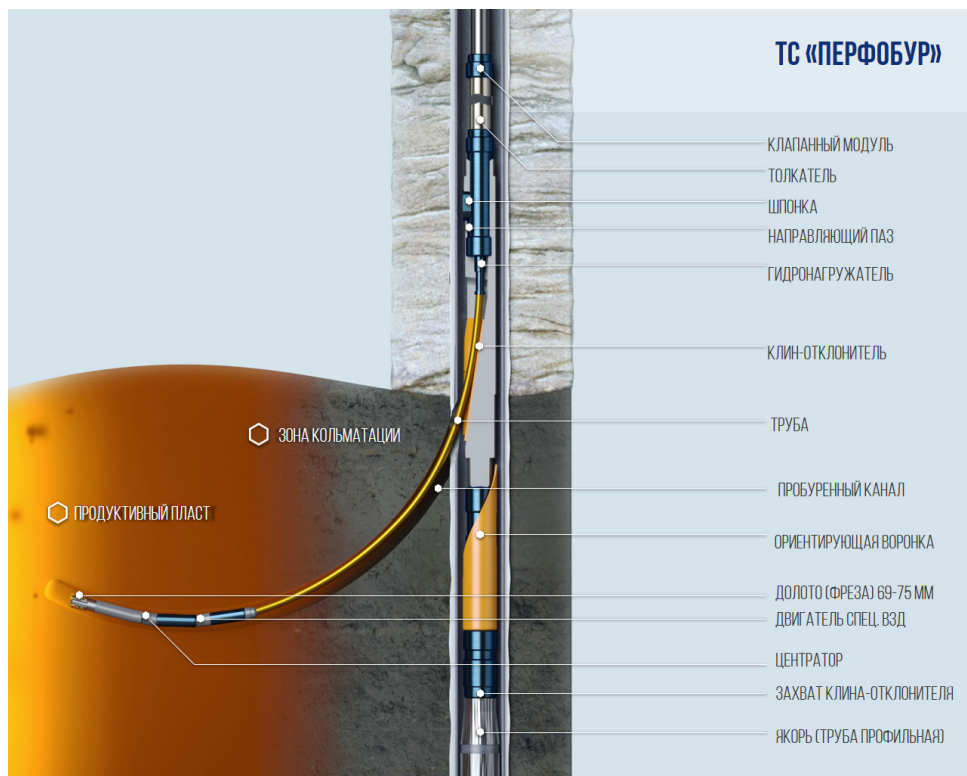
Рисунок 2. Основные элементы технической системы Перфобур
