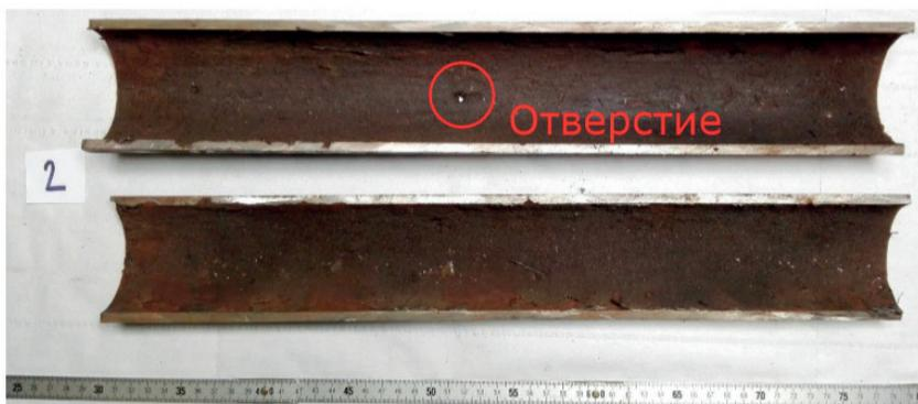
Рисунок 8. Питтинговая коррозия. Сталь марки N80 Q API 5CT PSL1 из скв. № 3626
