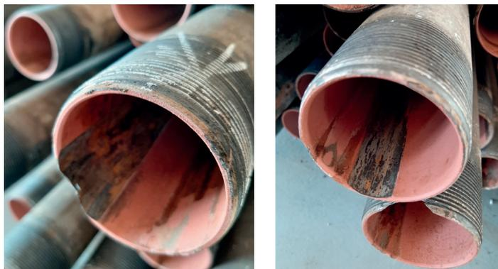
Рисунок 6. НКТ с защитным покрытием МРАG96 из скв. № 6908
