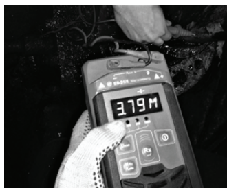
Рисунок 4. Замер изоляции цепи НКТ-насос-колонна штанг на скв. 68А
