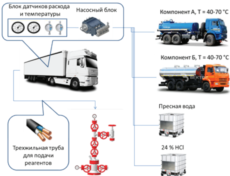
Рисунок 4. Схема закачки экзотермических составов в пласт
