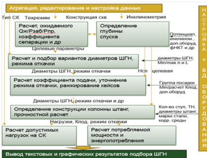
Рисунок 4. Схема алгоритмов расчёта подсистемы модуля «Подбор ШГН»
