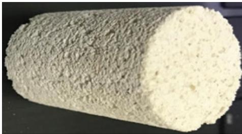
Рисунок 4. Образец ячеистого газобетона
