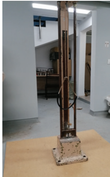
Сурет 2. Тампонаж тасының үлгілерін сынақтан өткізуге арналған тік динамикалық қада (копер) [14]
