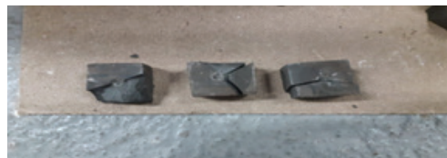
Сурет 5. Құрамында шырмаушы күшейткіш қоспасы жоқ цемент тасының соққылау әдісі арқылы зерттеу нәтижесі Figure 5. Result of an impact study on cement stone that does not contain an ivy enhancer additive
