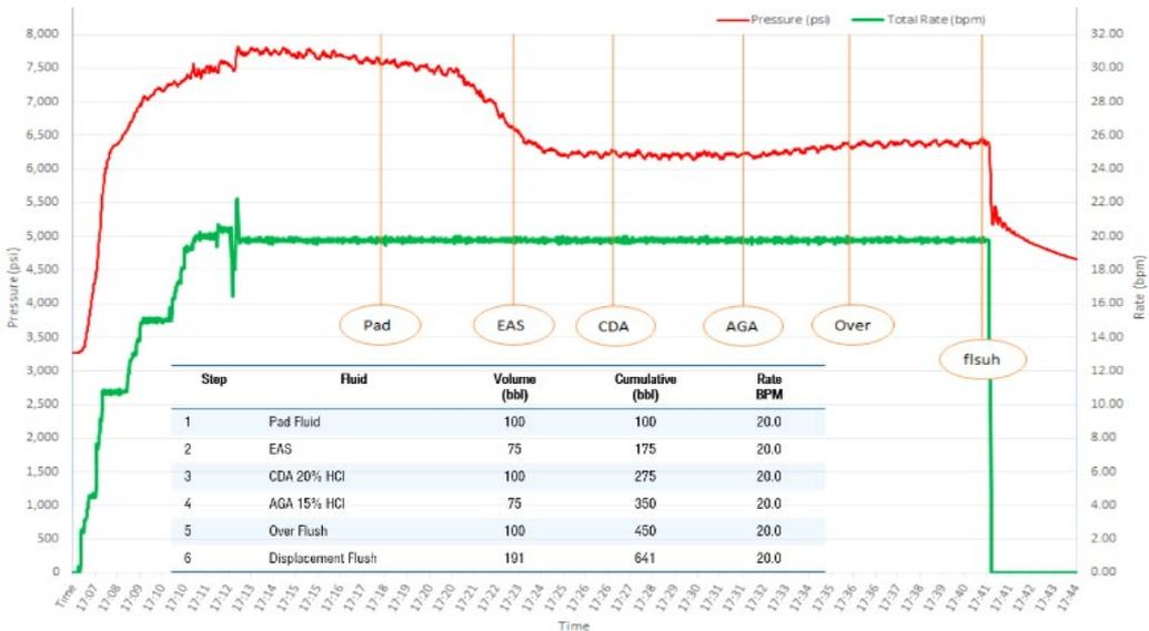
**Рисунок 3. Пример кГРП на высокотемпературном карбонатном объекте**
