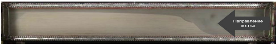
Рисунок 2. Тестирование потока пропанта: кварцевый песок [23] Figure 2. Proppant flow testing: silica sand [23]
