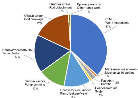
Рисунок 2. Основные причины отказов ГНО Figure 2. Main causes of downhole pumping equipment failures
