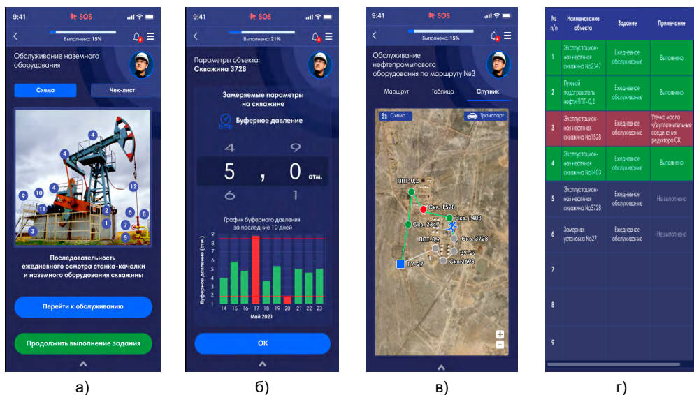
Рисунок 1. Рабочие панели ежедневного обслуживания НПО Figure 1. Daily maintenance dashboards for oilfield equipment
