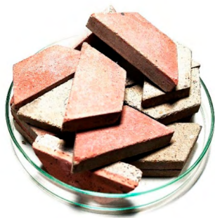
Рисунок 4. Особенности текстуры материала брикета (бурового шлама) Figure 4. Features of the briquette material texture (drilling sludge)
