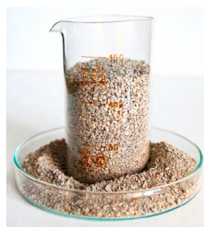
Рисунок 3. Эффект гравитационной сегрегации, наблюдаемой при перемещении шихты
