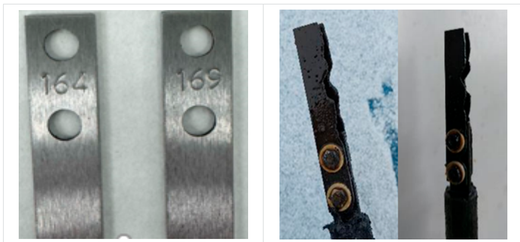
а) б) Рисунок 10. Внешний вид ОСК до и после установки на УПН «Б» Figure 10. Corrosion coupons before and after installation at OTR «B»
