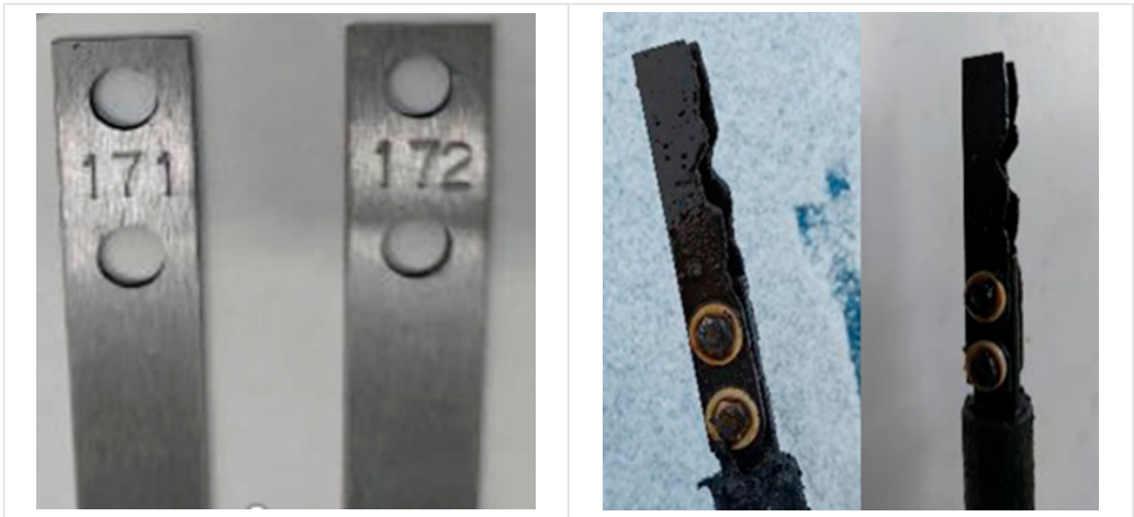
Рисунок 5. Внешний вид ОСК до и после установки на ЦППН «А»
